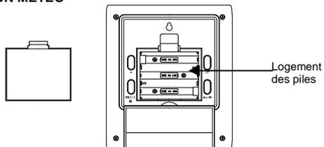
La station météo fonctionne avec 3 piles 1,5V de type AA IEC LR6 (non incluses). Pour installer et remplacer les piles :
