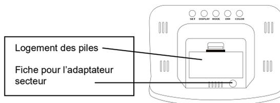
La station météo fonctionne avec 2 piles 1,5V de type AA, IEC LR6. L'alimentation principale de la station doit néanmoins être le branchement sur secteur.
