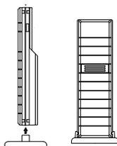
L'émetteur est fourni avec un support qui peut être fixé à un mur au moyen des deux vis fournies.
