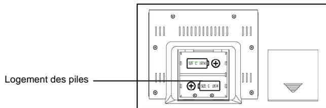
Le récepteur météo fonctionne avec 2 piles 1,5V de type C, IEC LR14.
