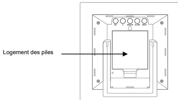
Le récepteur météo fonctionne avec 2 piles 1,5V de type C, IEC LR14 incluses.
