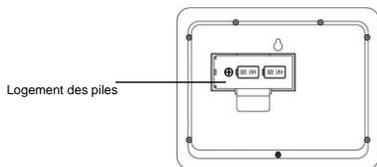
Le récepteur météo fonctionne avec 2 piles 1,5V de type C, IEC LR14.
