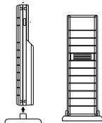
L'émetteur est fourni avec un support qui peut se fixer au mur à l'aide des deux vis fournies. Il peut aussi être posé sur une surface plane en enclenchant l'émetteur sur le support.
