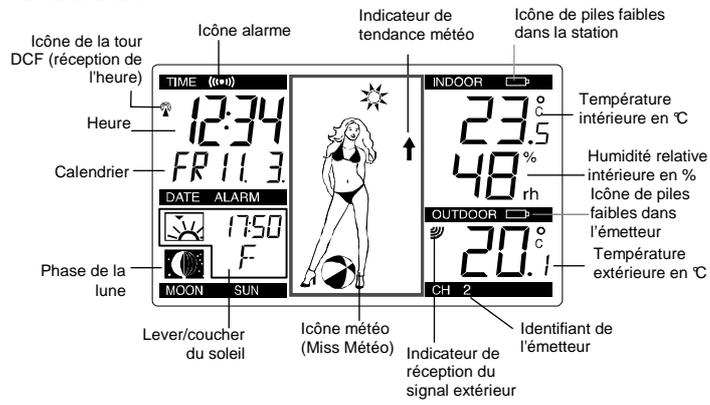
\* Lorsque le signal de l'émetteur extérieur est réceptionné par la station météo, l'indicateur de réception du signal extérieur reste affiché à l'écran (l'icône ne sera pas affichée si la
