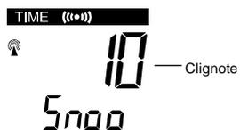
La temporisation de la fonction "Snooze" (= répétition de l'alarme) peut être désactivée (OFF) ou réglée jusqu'à un maximum de 30 minutes (10 minutes par défaut) :
