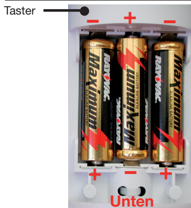
Batterien einlegen, Lage des Tasters
